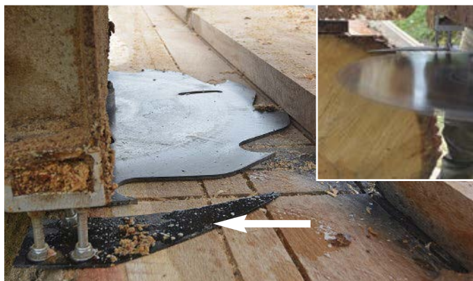
Die weiten Spanlücken zwischen den Sägezähnen produzieren lange Späne, damit der Schnitt nicht verstopft. Eine Führungsschiene (Pfeil großes Bild) und ein Sägeblattstabilisator (Pfeil kleines Bild) sorgen dafür, daß der Schnitt nicht verläuft. Die Schnittrillen auf diesem Foto sind untypisch, weil die Säge falsch eingestellt war. Richtig ausgerichtet, wird das Holz glatt vom Stamm gesägt.
