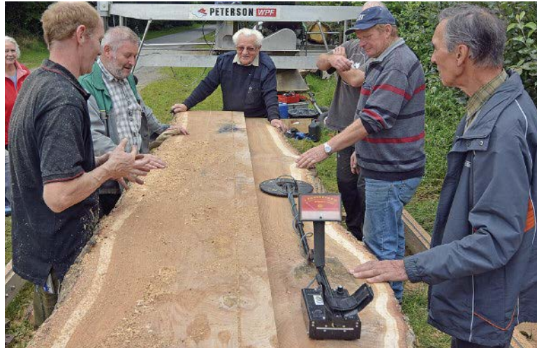
Die Boots-Freunde rund um Ulf Stühmer-Jacobsen und Kurt Scharlibbe (v.l.) begutachten die aufgesägte Eiche. An zahlreichen Stellen hat sie sich schwarz verfärbt – ein deutliches Indiz für eingewachsenes Eisen. Dünnere Drähte wie rechts im Bild können dem Sägeblatt zwar kaum schaden, bei stärkeren Krampen aber brechen die Zähne. Weil der Metalldetektor auch an vermeintlich eisenlosen Stellen anschlägt, werden mehrere große Blöcke abgesehen und der Stamm so halbiert. Dann schweigt der Detektor.
