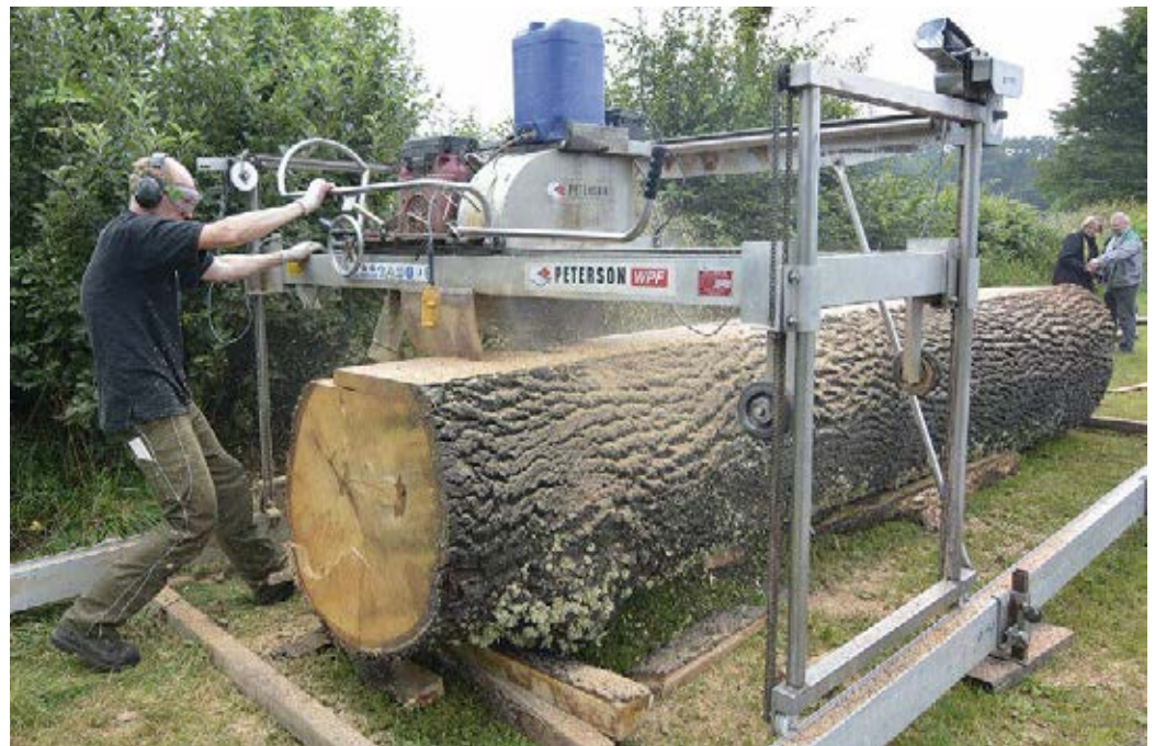
Das Kreissägeblatt des Peterson WPF sägt waagerechte Schnitte in der Vorwärtsbewegung und senkrechte Schnitte beim Zurückziehen des Laufwagens. Die maximale Schnitttiefe liegt jeweils bei knapp 26 Zentimetern. Alternativ ließe sich ein Stamm wie dieser mit einer Kettensägen-Schneidgarnitur auch auf ganzer Breite zersägen.
