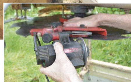
Eine Schwenkmechanik dreht das Sägeblatt in eine senkrechte Stellung. Die Sägezähne lassen sich mit einem Schärfgerät pflegen, das Strom von der bordeigenen Autobatterie bezieht.
