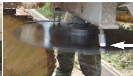
Durch die spezielle Schnitttechnik lassen sich starke Durchmesser wie bei dieser Eiche optimal ausnutzen – ohne den Stamm einmal wenden zu müssen.
