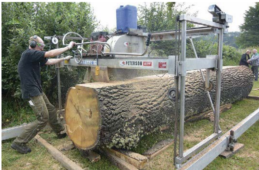
Das Kreissägeblatt des Peterson WPF sägt waagerechte Schnitte in der Vorwärtsbewegung und senkrechte Schnitte beim Zurückziehen des Laufwagens. Die maximale Schnitttiefe liegt jeweils bei knapp 26 Zentimetern. Alternativ ließe sich ein Stamm wie dieser mit einer Kettensägen-Schneidgarnitur auch auf ganzer Breite zersägen.
