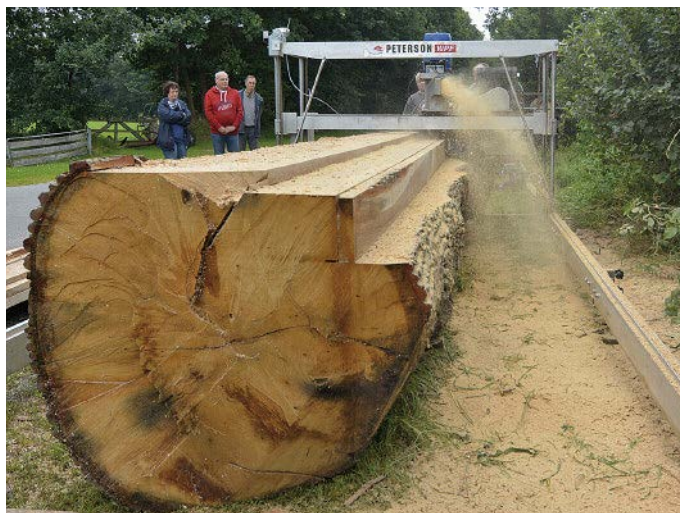
Durch die spezielle Schnitttechnik lassen sich starke Durchmesser wie bei dieser Eiche optimal ausnutzen – ohne den Stamm einmal wenden zu müssen.
