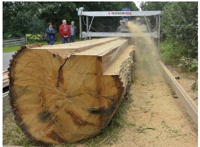
Durch die spezielle Schnitttechnik lassen sich starke Durchmesser wie bei dieser Eiche optimal ausnutzen – ohne den Stamm einmal wenden zu müssen.
