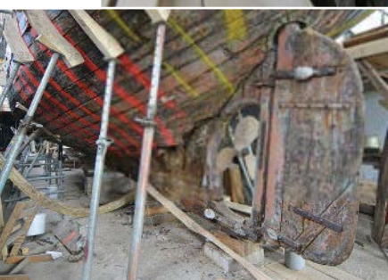
Das Eichenholz der über Deck knapp 15 Meter langen Cleone muß zu großen Teilen erneuert werden. Die wesentliche Technik wie die Rudersteuerung, der Anker und ein Ford-Vierzylinder-Dieselmotor mit 78 PS sind aber intakt. Das Deck und der bereits abmontierte Decksalon aus Burma-Teak sind am besten erhalten, weil das ölhaltige Teakholz nur wenig verwittert.
