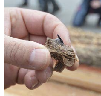
Die Boots-Freunde rund um Ulf Stühmer-Jacobsen und Kurt Scharlibbe (v.l.) begutachten die aufgesägte Eiche. An zahlreichen Stellen hat sie sich schwarz verfärbt – ein deutliches Indiz für eingewachsenes Eisen. Dünnere Drähte wie rechts im Bild können dem Sägeblatt zwar kaum schaden, bei stärkeren Krampen aber brechen die Zähne. Weil der Metalldetektor auch an vermeintlich eisenlosen Stellen anschlägt, werden mehrere große Blöcke abgesehen und der Stamm so halbiert. Dann schweigt der Detektor.
