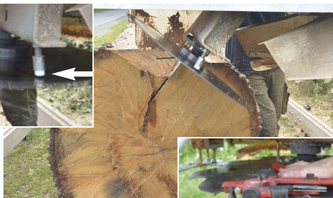
Eine Schwenkmechanik dreht das Sägeblatt in eine senkrechte Stellung. Die Sägezähne lassen sich mit einem Schärfgerät pflegen, das Strom von der bordeigenen Autobatterie bezieht.
