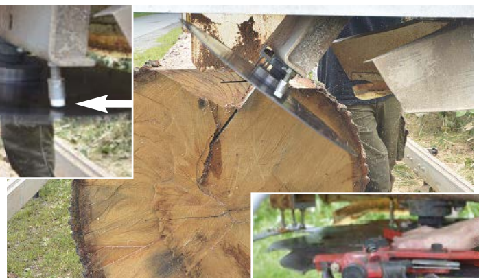
Eine Schwenkmechanik dreht das Sägeblatt in eine senkrechte Stellung. Die Sägezähne lassen sich mit einem Schärfgerät pflegen, das Strom von der bordeigenen Autobatterie bezieht.
