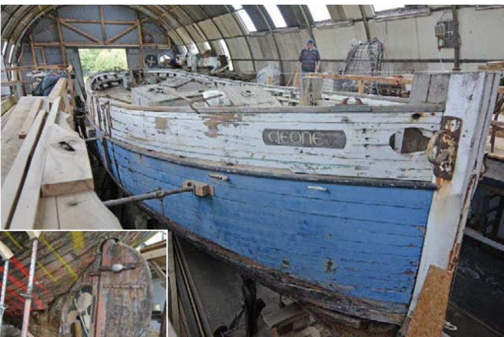
Das Eichenholz der über Deck knapp 15 Meter langen Cleone muß zu großen Teilen erneuert werden. Die wesentliche Technik wie die Rudersteuerung, der Anker und ein Ford-Vierzylinder-Dieselmotor mit 78 PS sind aber intakt. Das Deck und der bereits abmontierte Decksalon aus Burma-Teak sind am besten erhalten, weil das ölhaltige Teakholz nur wenig verwittert.
