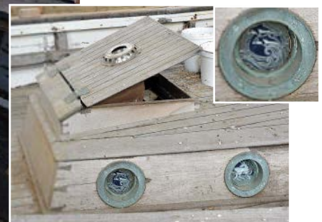
Das Eichenholz der über Deck knapp 15 Meter langen Cleone muß zu großen Teilen erneuert werden. Die wesentliche Technik wie die Rudersteuerung, der Anker und ein Ford-Vierzylinder-Dieselmotor mit 78 PS sind aber intakt. Das Deck und der bereits abmontierte Decksalon aus Burma-Teak sind am besten erhalten, weil das ölhaltige Teakholz nur wenig verwittert.
